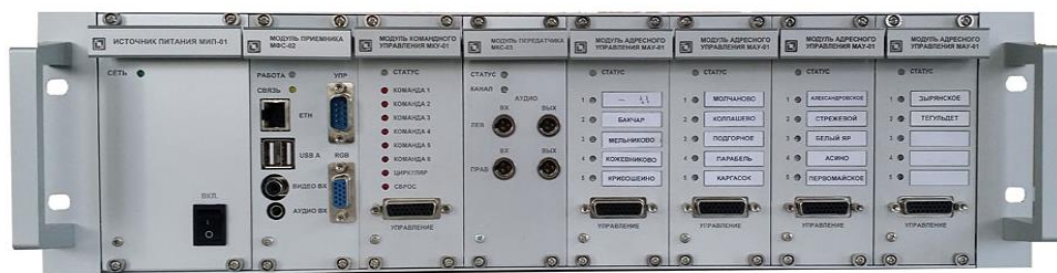
Рис 4.2 Коммутатор П-166 ИТК ОС СП
